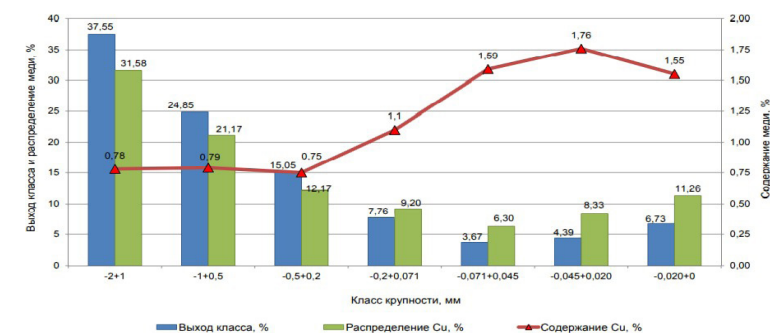
Рисунок 1 – Гранулометрическая характеристика пробы руды Актогайского месторождения с распределением меди по классам крупности
