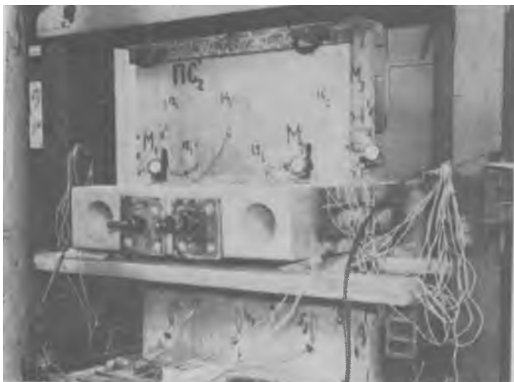
Рисунок 2 – Испытание платформенного стыка в прессе
